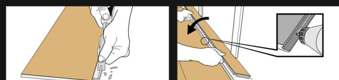
Демонтируйте замок, как показано на рисунке. Для соединения плашек используйте клей. Установите клинья между проклеенной плашкой и стеной и прижмите.
