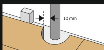
Необходимо соблюдать монтажные деформационные зазоры не менее 10 мм от края покрытия до выдающихся над поверхностью пола элементов (трубы, лестницы, колонны, перегородки, пороги и т.п.)
