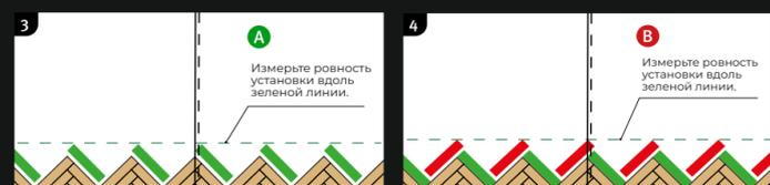
Установите А-образные плашки, как показано на рисунке. Тщательно проверьте стык между плашкой А и треугольником. Не должно быть никаких выступающих краёв! Отрежьте левый край так, чтобы он соответствовал размеру помещения (10 мм). Проверьте ровность зеленой линии (см. рисунок). На протяжении всего монтажа повторяйте измерения с помощью линейки, отбивочной линии. При возникновении отклонений устраните их (см. схемы ниже).
